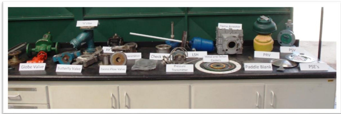
Figura 5 - Bancada de dispositivos de segurança dos processos
